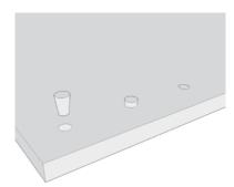
• Parti danneggiate in modo più sostanziale dovranno essere asportate con un utensile conico e riparate tramite l'incollaggio di un pezzo in pRaL® adatto allo scopo.
