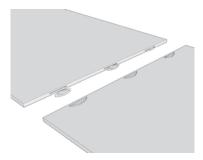
o Suggerimento: In caso di fresatura o taglio grezzo dei bordi, carteggiare le due estremità da giuntare e la superficie della striscia di rinforzo con carta abrasiva con grana 150/180. Utilizzare un tampone abrasivo in modo che la levigatura venga effettuata in piano e per impedire che i margini risultino arrotondati.
